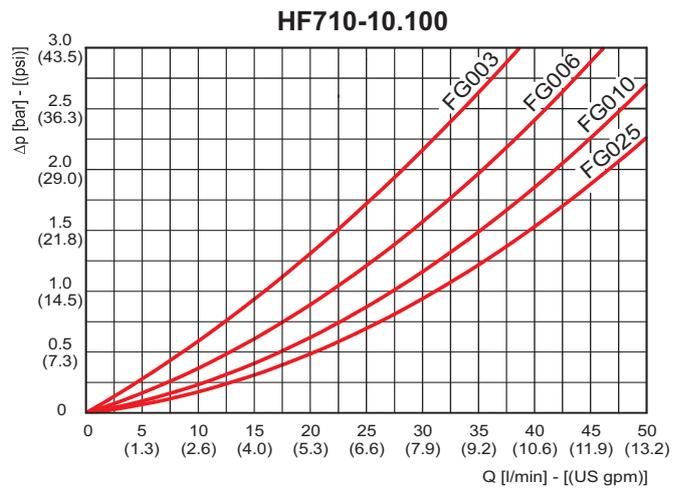
I diagrammi sono determinati dalle seguenti condizioni: Olio minerale tipo SAE 10, viscosità cinematica 30 cSt, densità 0,856 kg/dm<sup>3</sup>.
