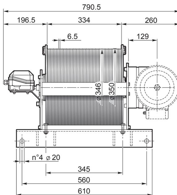
**L' ARGANO VIENE FORNITO SENZA MOTORE / HOIST DELIVERED WITHOUT MOTOR**
