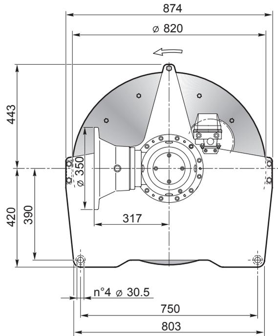
L' ARGANO VIENE FORNITO SENZA MOTORE / HOIST DELIVERED WITHOUT MOTOR
