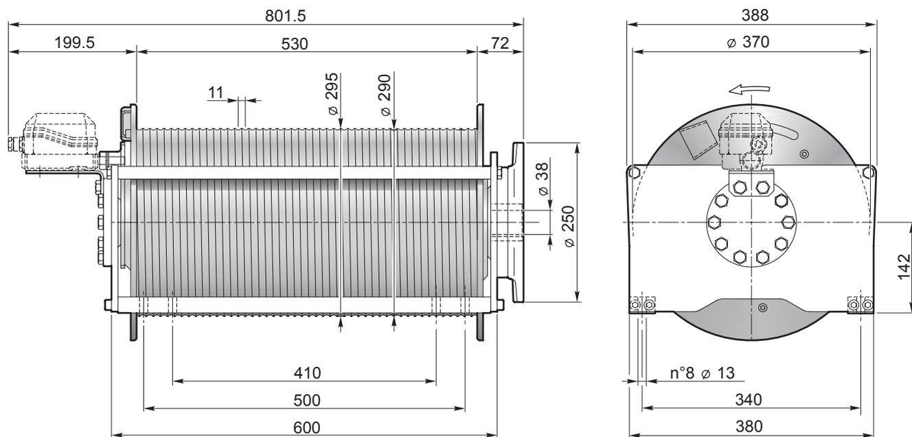
L' ARGANO VIENE FORNITO SENZA MOTORE / HOIST DELIVERED WITHOUT MOTOR
