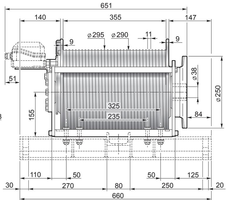
L' ARGANO VIENE FORNITO SENZA MOTORE / HOIST DELIVERED WITHOUT MOTOR
