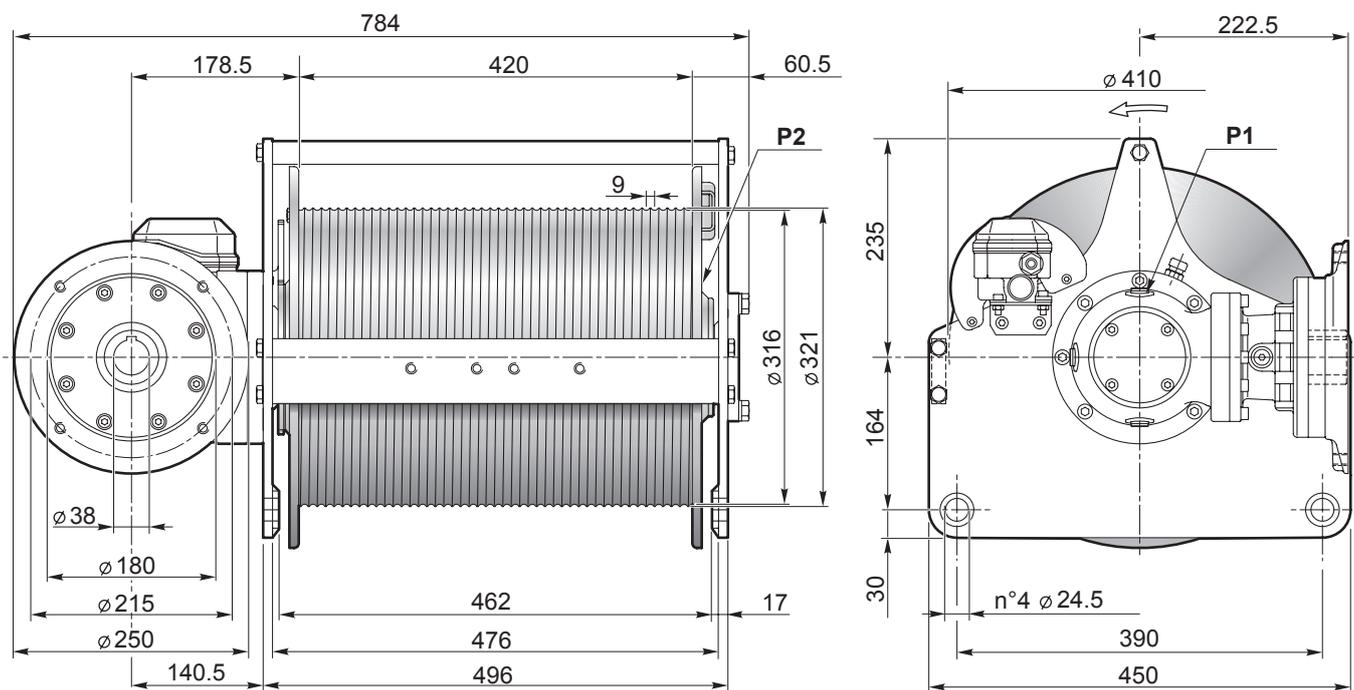
L' ARGANO VIENE FORNITO SENZA MOTORE / HOIST DELIVERED WITHOUT MOTOR
