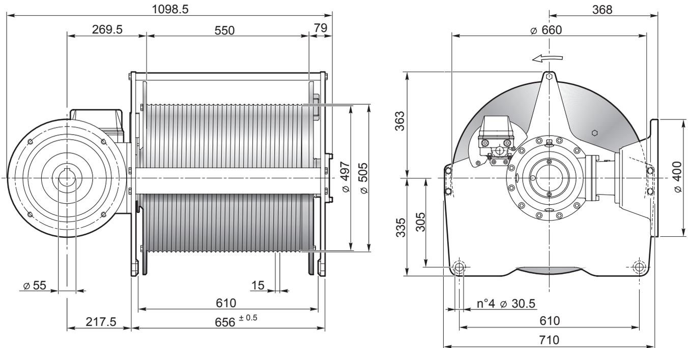
L' ARGANO VIENE FORNITO SENZA MOTORE / HOIST DELIVERED WITHOUT MOTOR
